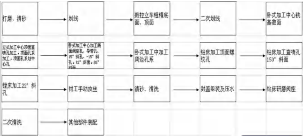
图 4.2-6 汽缸盖加工生产流程图
